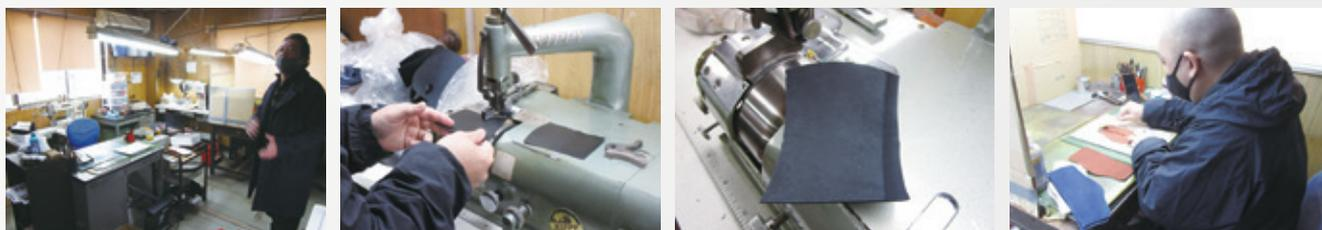
次に3階「材料置き場」「仕上げ作業場」、クリーピング、品番サイズ刻印、仕上げ、ブーツの時期では、1足1足クリーピングを行っているそうです。
