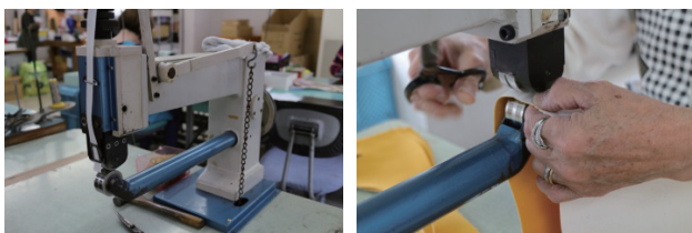
ローラーミシン (2台) …踵の補強テープを貼るミシン
