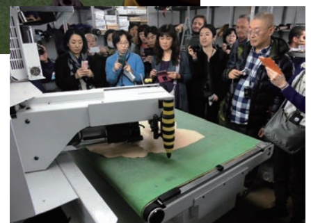
型紙からアッパーを レーザーで自動作成 できる。
