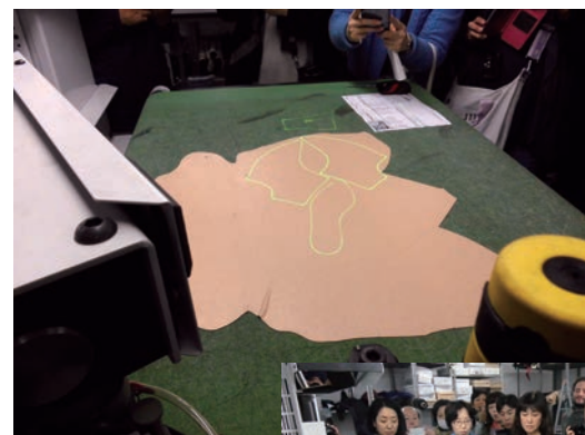
型紙からアッパーを レーザーで自動作成 できる。
