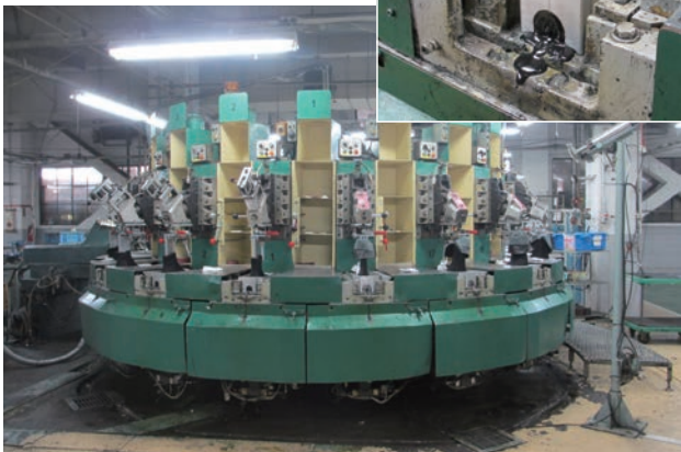
PU インジェクション製法機全景
