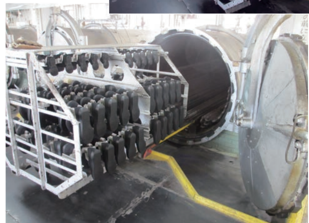
加硫の窯に入る前 (バルカナイズ製法)
