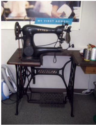
製甲用ミシン 外反母趾対応の加工 子供靴のハイカット加工など
