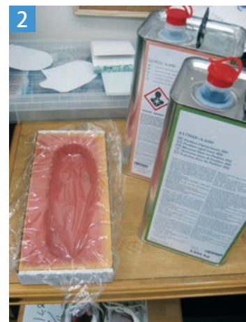
2 サランラップをのせ ①② 2液を混ぜて流し込み固める
