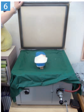
6 真空整形機を使い全体を固定
