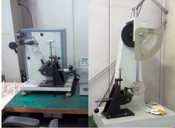
ヒール疲労試験器 2万回叩いて折れなければOK。
