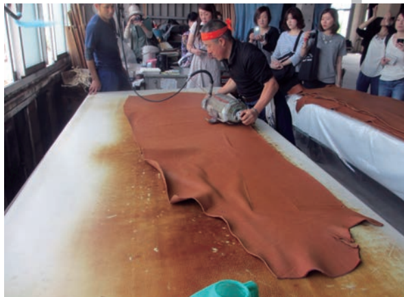
伸びにくい革は重さ30kgのハンドセッターで伸ばす。
