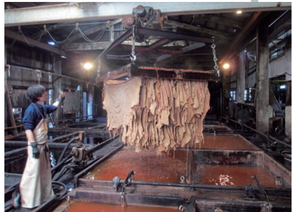
ピット槽は4段階の濃度に分けられクレーンに吊られ、薄い→濃い の順番に漬けていく。通常で約20日間。長いと8カ月漬けることも！
