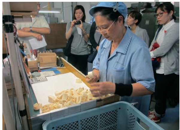
機械を通した後に再度、人間の目でチェック。 徹底した品質管理！
