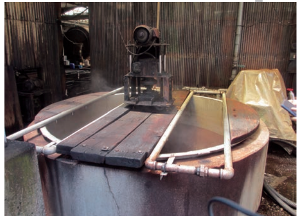
タンニン溶解液の槽。使用するタンニンは 高品質のブラジル産ミモザ。
