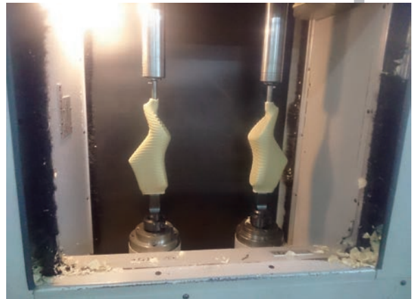
靴型もコンピューター制御で自動作成。 高速回転して削られます。
