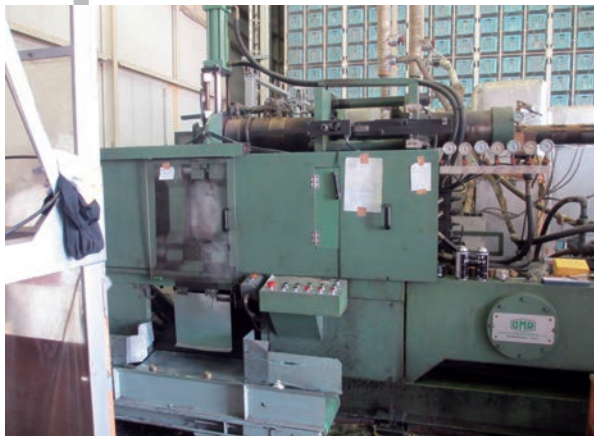
靴型の元となるプラスチックのブロックを成形する機械。
