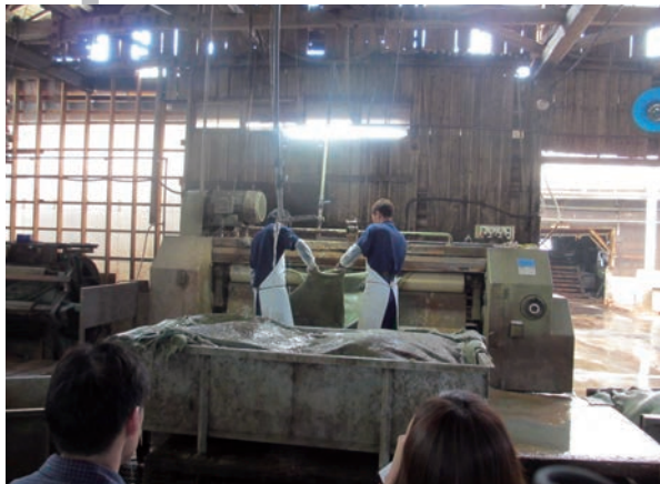
ローラーに挟み込んで肉面に付着した 不要な皮下組織、肉塊、脂肪や汚れを落とす。
