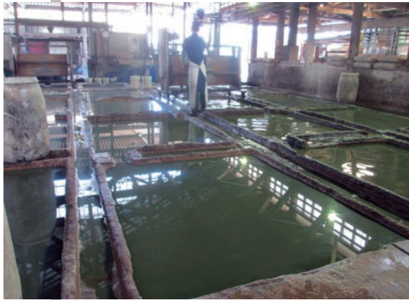
石灰漬けのピット槽で脱毛。
