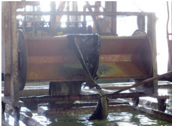
ピット槽は濃度が5段階に分かれ ローラーを使って順番に移していく。
