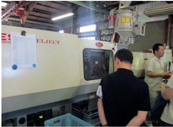
ヒールを作る機械。1分くらいで1個製造。
