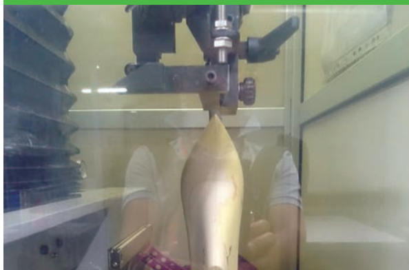
靴型のマスターモデル（木製）もコンピューター制御で自動作成される。
