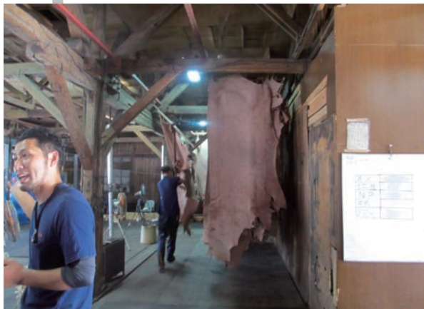
吊るして乾燥。男性が軽々と持ち上げているが重さは1枚30kg！
