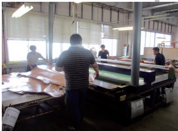
革は面積で価格が決まる。値段の単位はデシ(1デシは10cm×10cm)で計算。光電式の計量器にかけ、革の面積を測る。
