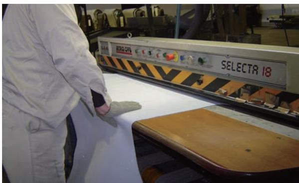
パフイング：種類用途に合わせてサンドペーパーで起毛加工
