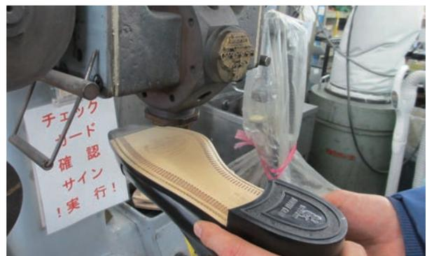
底マーク押し：底マーク押しの前にサイズ印押しがある
