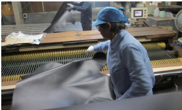
計量：計量機を通して坪面積が決定
