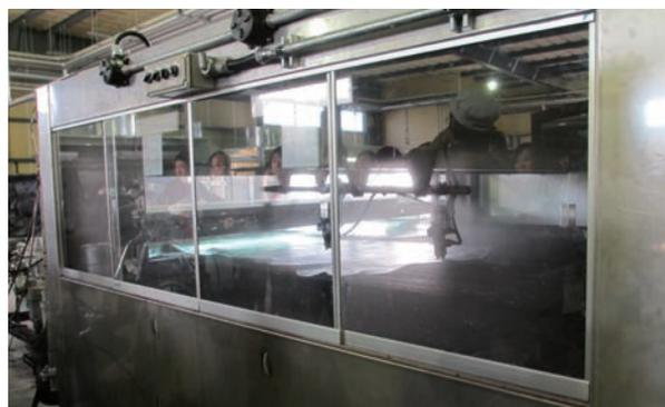
吹き付け：スプレーガンによる着色。手塗りの工程もある
