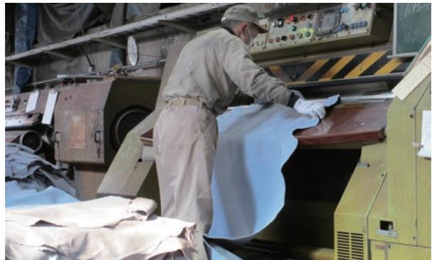
シェーピング：裏削りによって厚度を調整し均一にする
